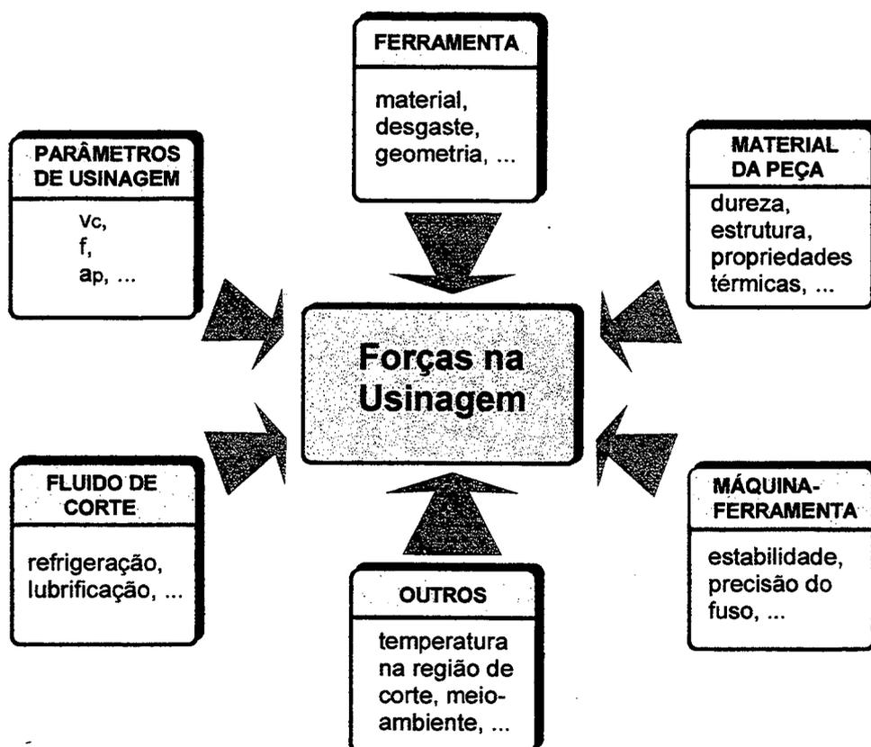
**Figura 2.16** - Fatores de influência sobre a força de usinagem [148]
