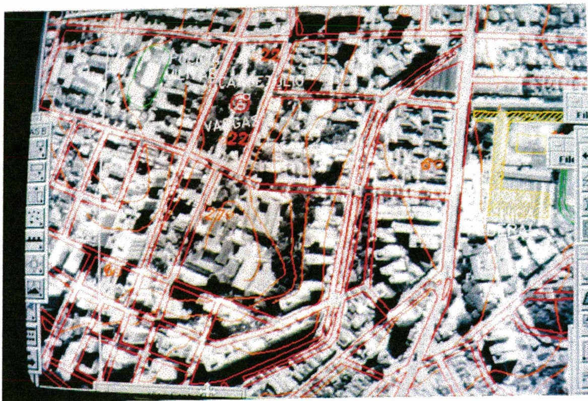
FIGURA 5.9: Arquivo vetorial da base antiga sobreposta à ortofoto digital (área I)
