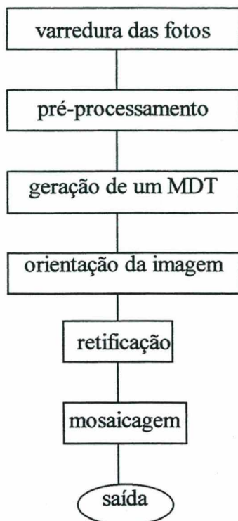
FIGURA 3.3: Esquema de geração de ortofoto digital
