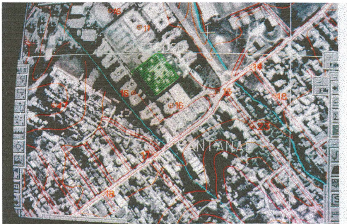
FIGURA 5.6: Superposição do arquivo vetorial da base antiga sobre a ortofoto digital
