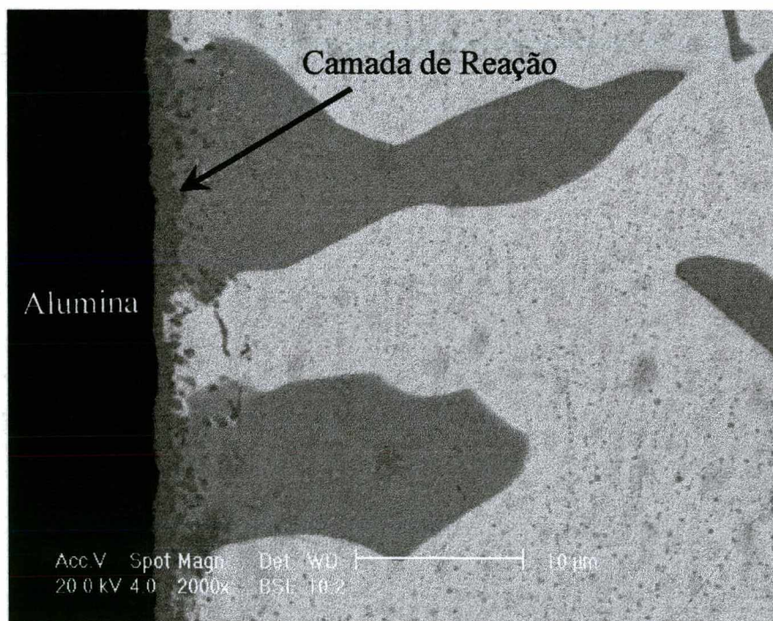
Figura 35 : Camada de reação da junta brasada a 750 °C por 30 minutos com Incusil ABA.
