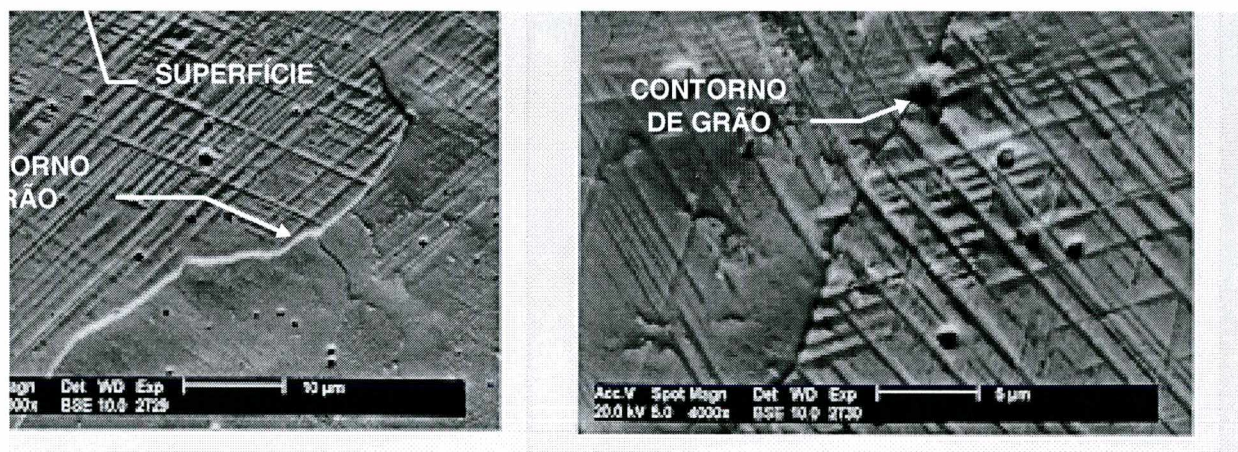
FIGURA 37. Seção transversal do corpo de prova E 725 após 70.000 seg. de ensaio de cavitação
