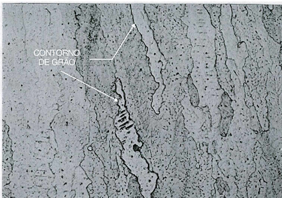
FIGURA 17. Microestrutura do depósito de solda E 725, ataque eletrolítico NaOH 200x
