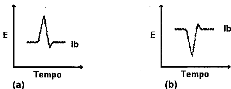
Figura 22. Formas dos sinais quando se emprega o método de injeção com borda coincidente com maior volume de ácido (a) e maior volume de base (b). lb = linha de base.
