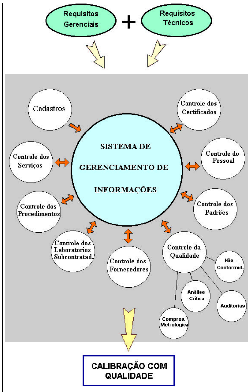
Figura 2.3 Requisitos abordados em um sistema de gerenciamento de informações para laboratório de calibração.
