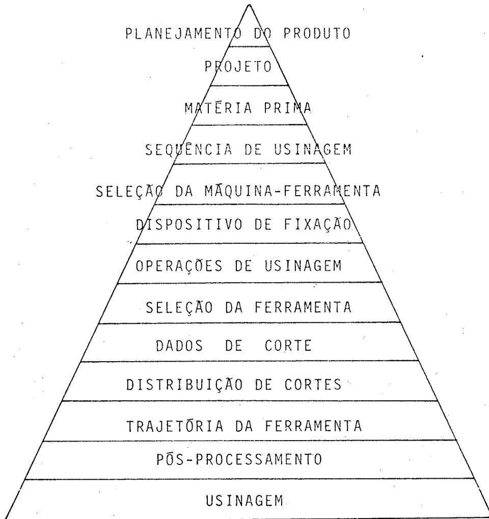
FIGURA 40 - Avanço da automatização do tratamento da informação na produção de peças usinadas.
