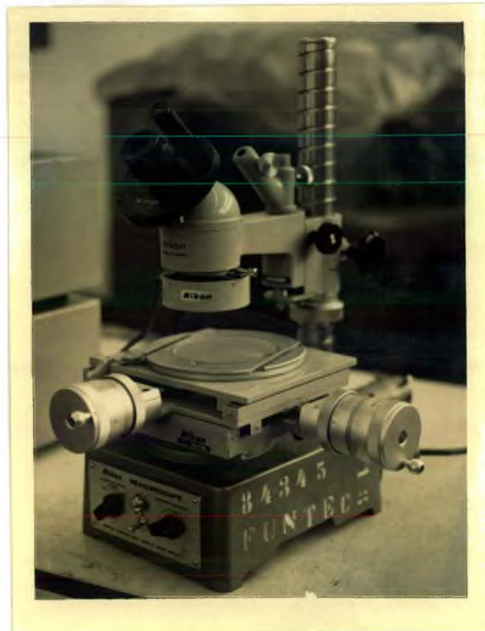
FIG. 19 - Microscópio de ferramentaria pa a medição do desgaste de flanco.
