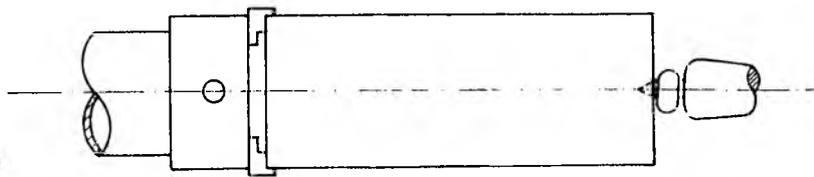
FIG. 18 - Fixação dos corpos de prova no torno
