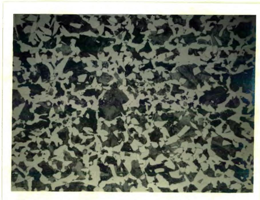
FIG. 08 - Micrografia do aço ABNT 1038, corpo de prova D, aumento 100X, ataque com nital 2%.
