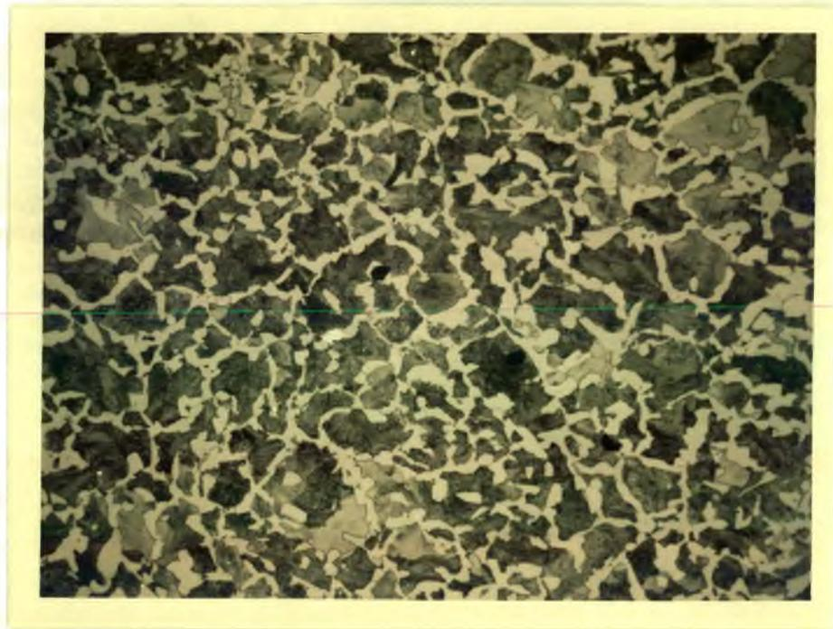
FIG. 06 - Micrografia do aço ABNT 1045, corpo de prova D, aumento 100X, ataque com nital 2%.
