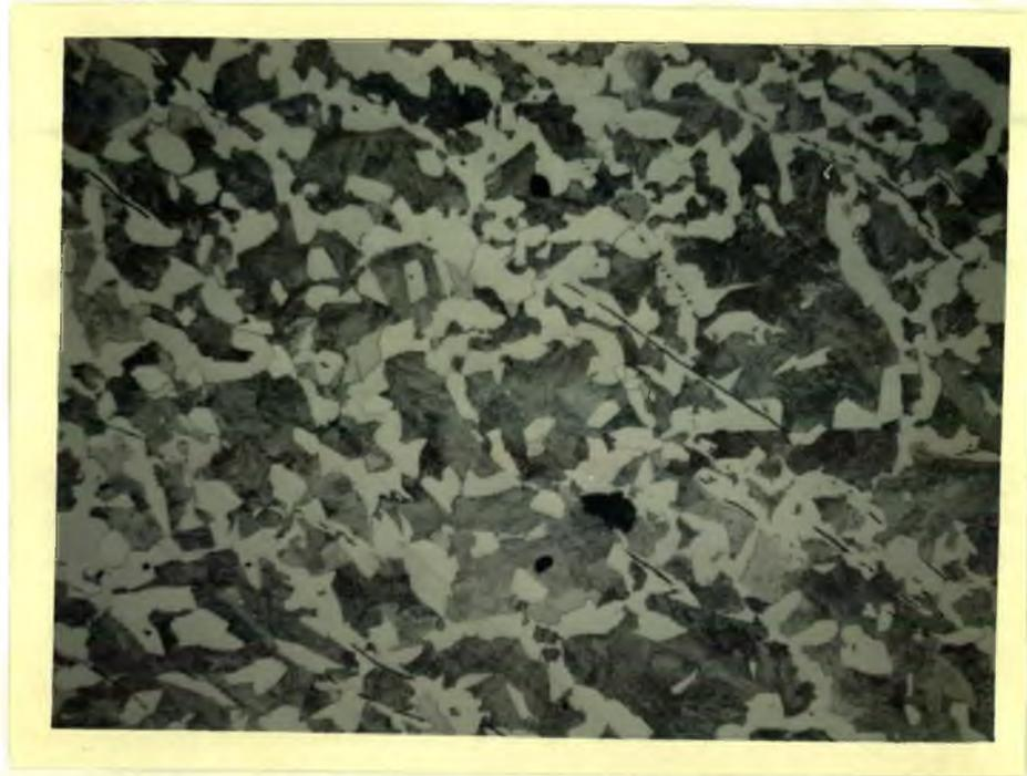
FIG. 07 - Micrografia do aço ABNT 1045, corpo de prova C, aumento 100X, ataque com nital 2%.
