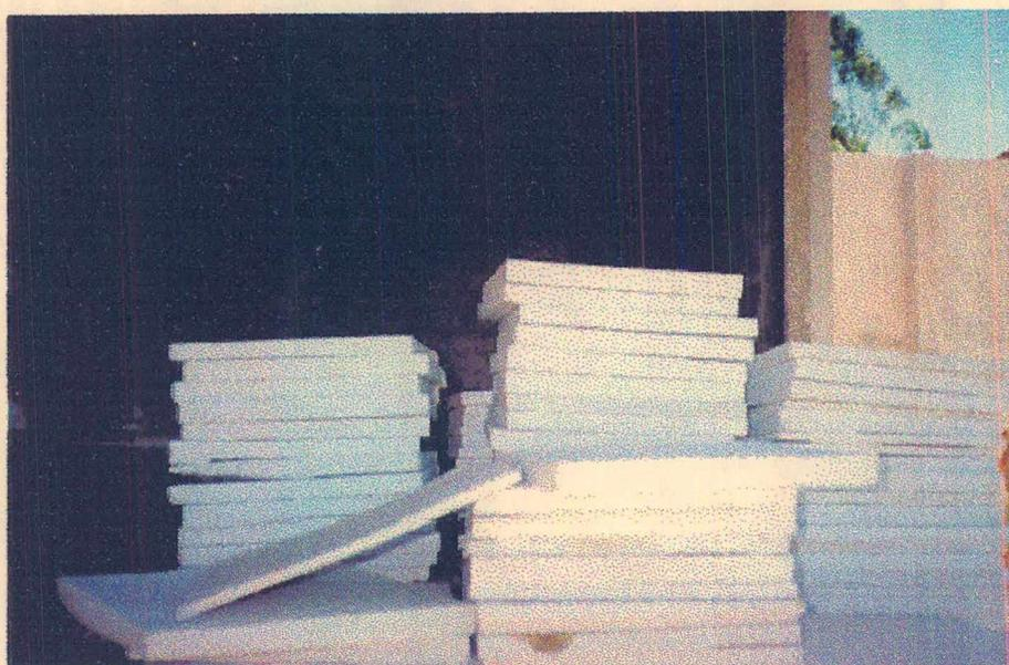
Foto 5.4. As peças para revestimento armazenadas onde destaca-se a variação de espessuras das mesmas.
