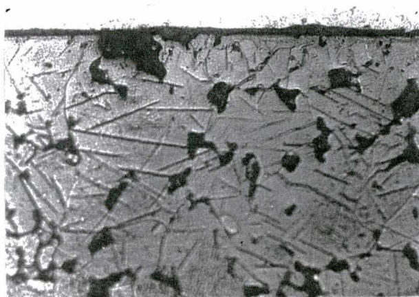
Fig. 4.2.2 - Microscopia ótica da liga Fe-puro sinterizada 1.0h/nitretada 2.0h.
