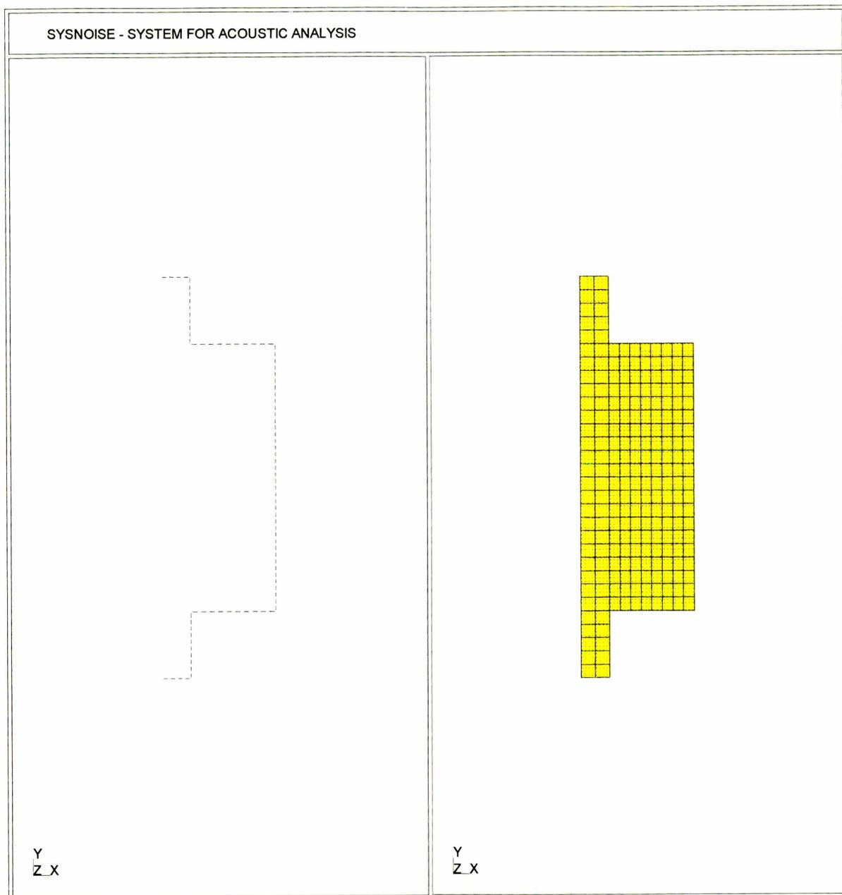
FIGURA 5.6 - Malhas utilizadas na análise da câmara de expansão simples pelo FEM axissimétrico (direita) e BEM axissimétrico (esquerda)
