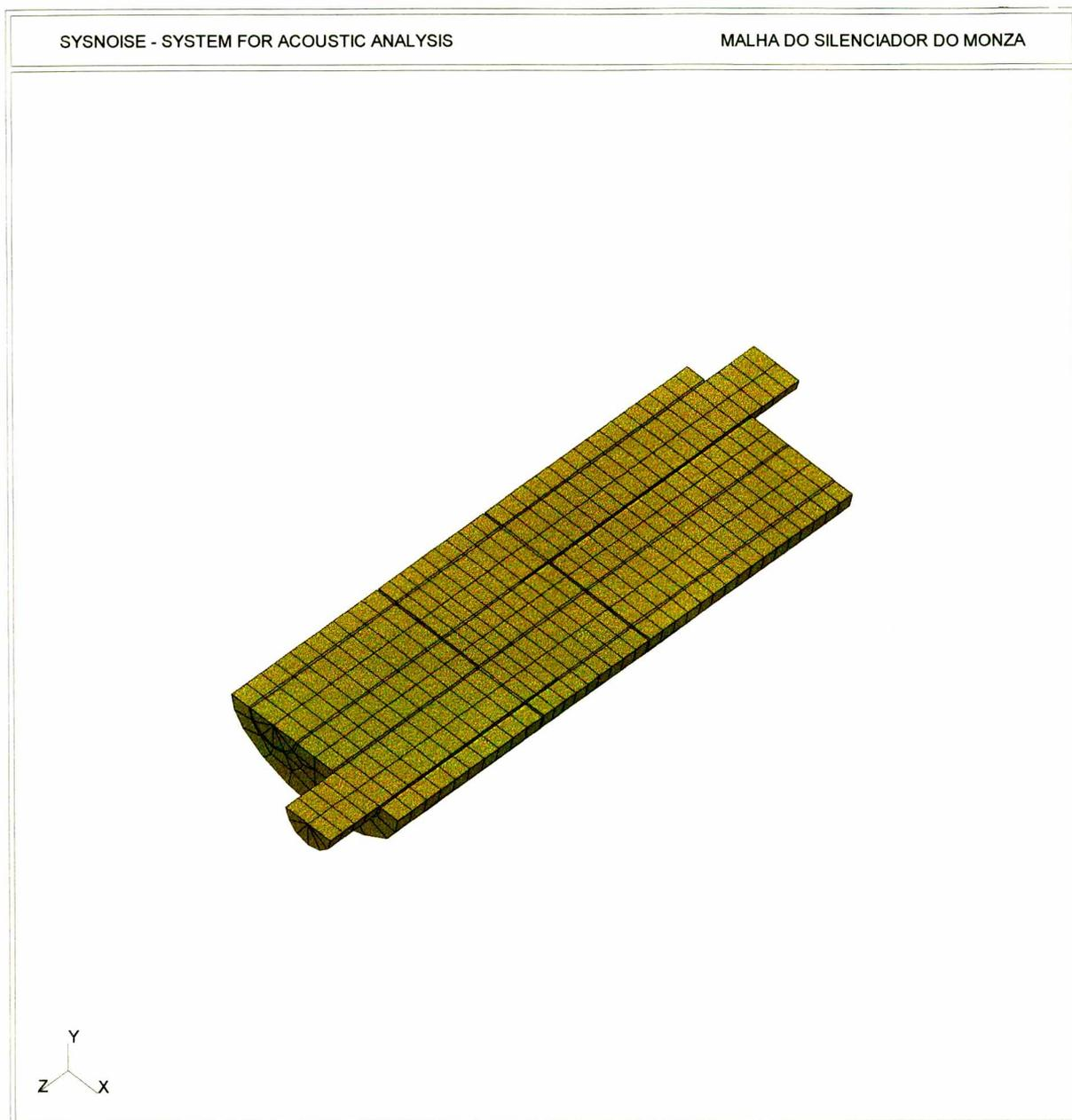
FIGURA 6.42 - Malha utilizada na análise do silenciador "real"
