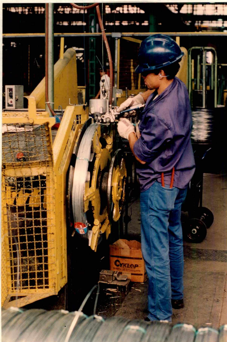
Figura 4.5 : Operador executando operação de cintagem sobre o material na máquina de embalar.
