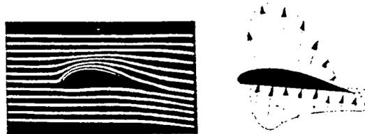
Fig. 1- Perfil da asa e fluxo do ar
