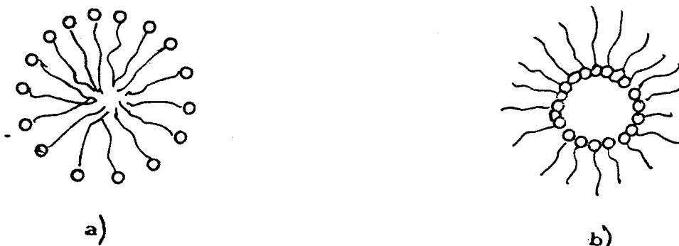
FIGURA 3. Esquema, em corte, de formas micelares correntes. a) normal; b) reversa.
