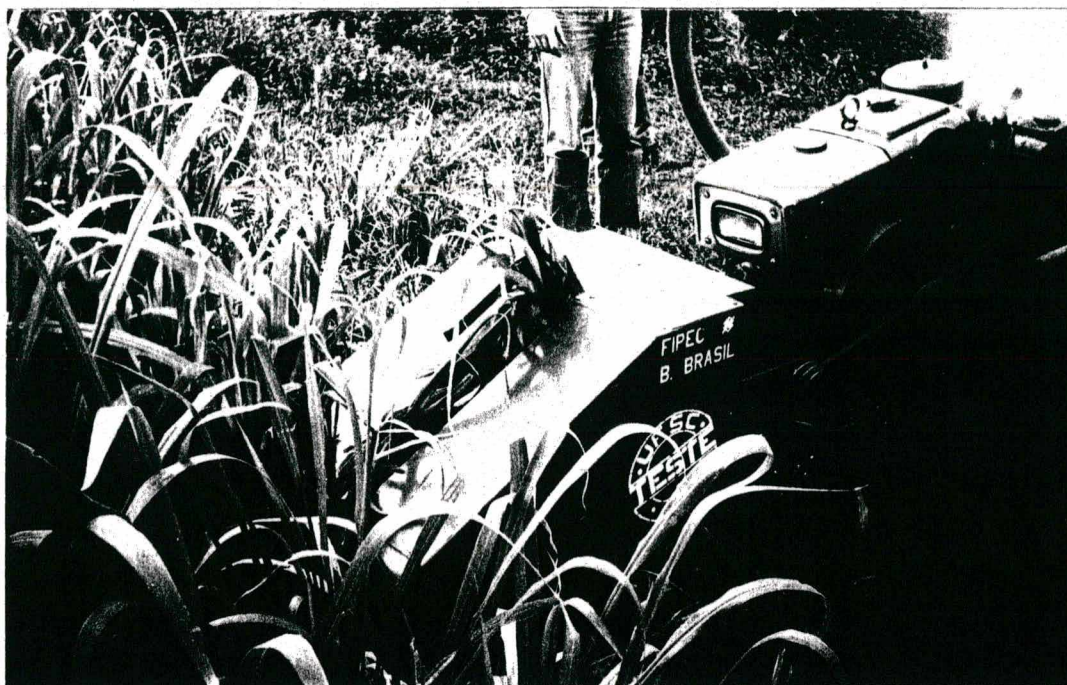
Fig. 8.12 - Detalhe mostrando o acúmulo de plantas entre o dispositivo de transporte e o de alimentação.
