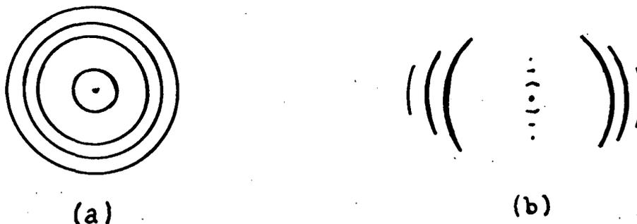
FIGURA 16 - Padrão de difração dos raios-X do esmético E, (a) não orientado e (b) orientado).
