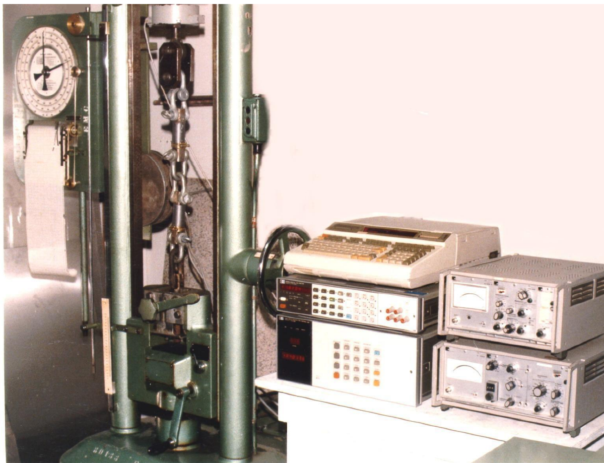
Fig. 3.5 - Calibração estática com aquisição automática
