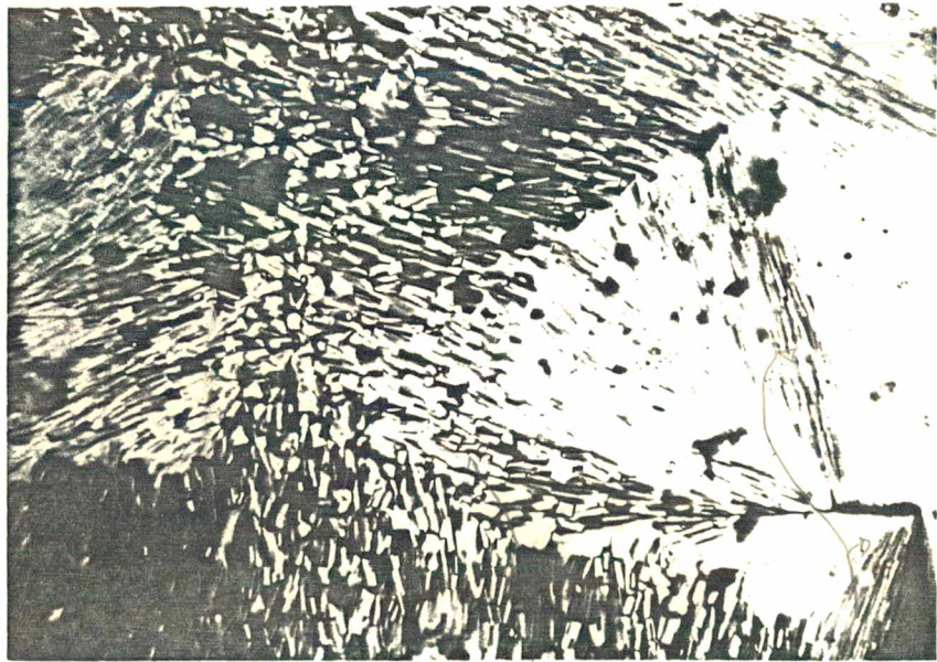
Fig. 36 - Fase Hexagonal. Texturas angular e estriada (não geométrica). Polarizadores cruzados, aumento 50 X.
