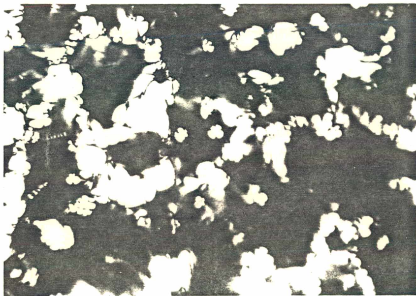
Fig. 34 - Transição da fase Nemática para Lamelar. À medida que diminui a temperatura, nota-se o aparecimento das texturas focais cônicas e das texturas pseudo-isotrópicas com "oily-streaks". Polarizadores cruzados, aumento 50 X.
