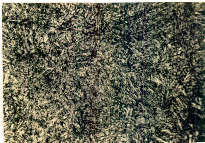
Figura 35 - Micrografia representativa do material temperado e revenido a 400°C, aumento 200 x, ataque Nital 2%.
