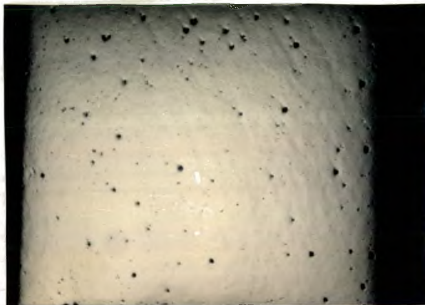
Fig. 3.8 - Micrografia sem ataque da seção transversal de aço com 2% MCM (densidade 7,1 \text{ g/cm}^3 ). Aumento: \frac{1 \text{ mm}} ; compactação com dupla ação.
