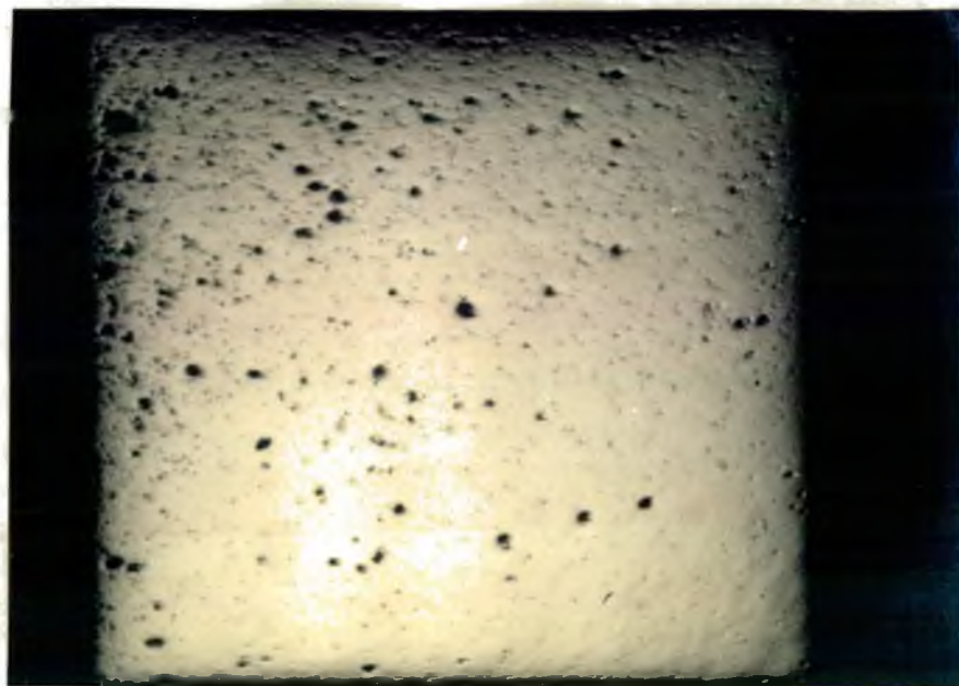
Fig. 3.7 - Micrografia sem ataque da seção transversal de aço com 2% MCM, (densidade 7,0 \text{ g/cm}^3 ). Aumento: \overline{1 \text{ mm}} ; compactação com dupla ação.
