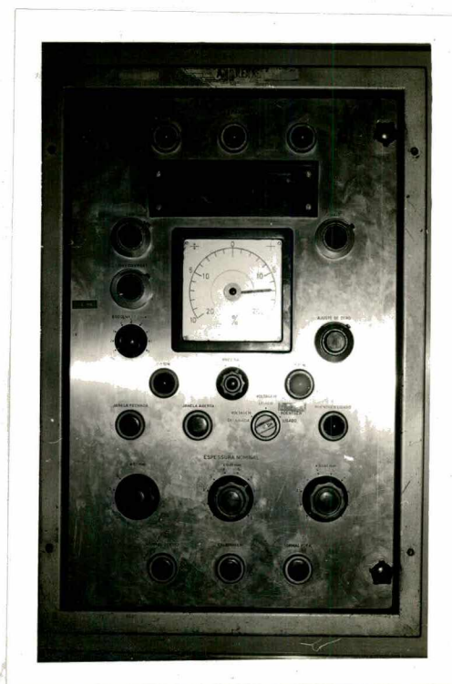
FIG. 15 - Esquema do sistema de medição e controle automático de espessura.
