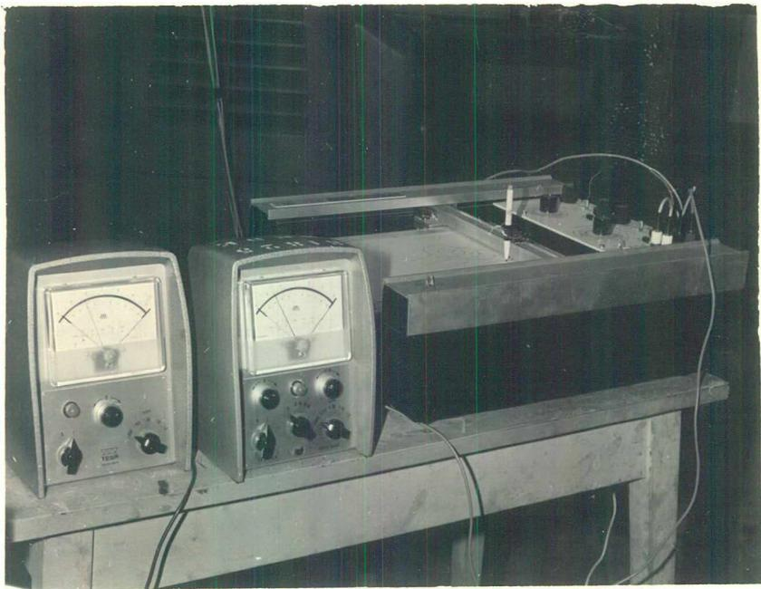
FIG. 17 - FOTO DOS APARELHOS DE MEDIÇÃO DE DEFORMAÇÕES (ITEM 2.2.1) E DO TRAÇADOR DE GRÁFICOS (ITEM 2.3)..
