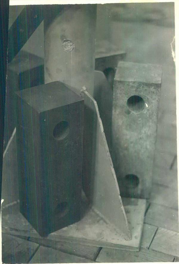
FIG.21— Coluna simplesmente apoiada com pesos na base.
