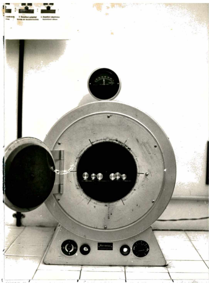
Fig. 26 - Estufa HERAEUS u tilizada para o recozimento dos corpos de prova.
