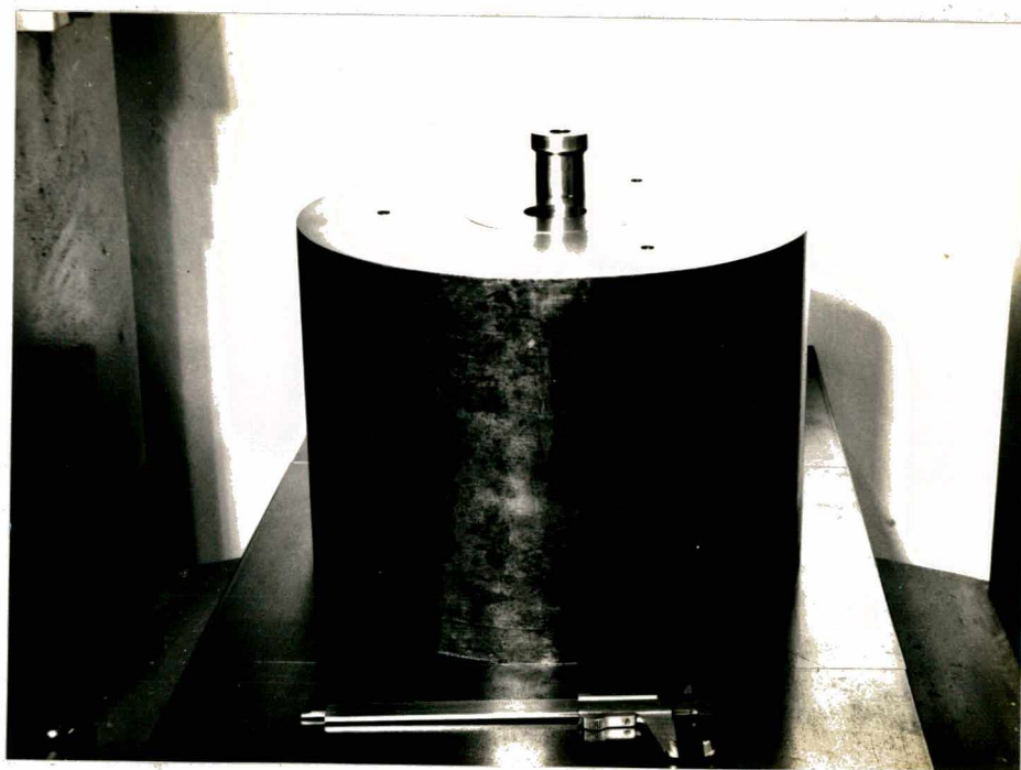
Fig. 4.16 - Detalhe do reservatório de pressão e da matriz de extrusão.
