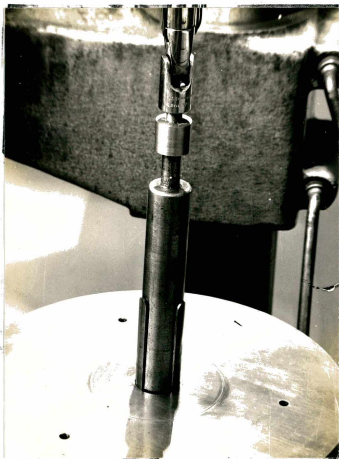
Fig. 4.8 - Detalhe do bruniamento da parte interna do reservatório de pressão.
