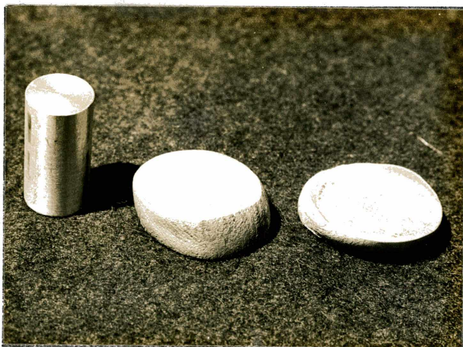
Fig. 4.42 - Detalhe do corpo de prova relação d_0/h_0 igual a 1/2 . Forma inicial, intermediária e final. Material: Alumínio .
