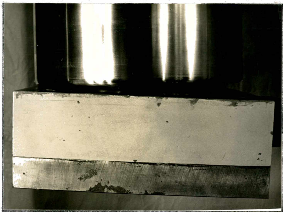
Fig. 8 - Pistão e placa superior da prensa (detalhe da possibilidade do movimento relativo da placa em relação ao cilindro).
