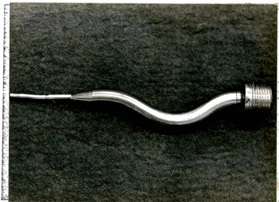
Fig. 4.40 - Deformação do corpo de prova em virtude do mesmo ter encostado na tampa de proteção dos condutores elétricos (tampão inferior da matriz).
