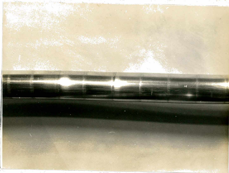
Fig. 4.39 - Defeito no produto extrudado. Marcas características do movimento de extrusão com 'stick-slip'. Material: Alumínio
