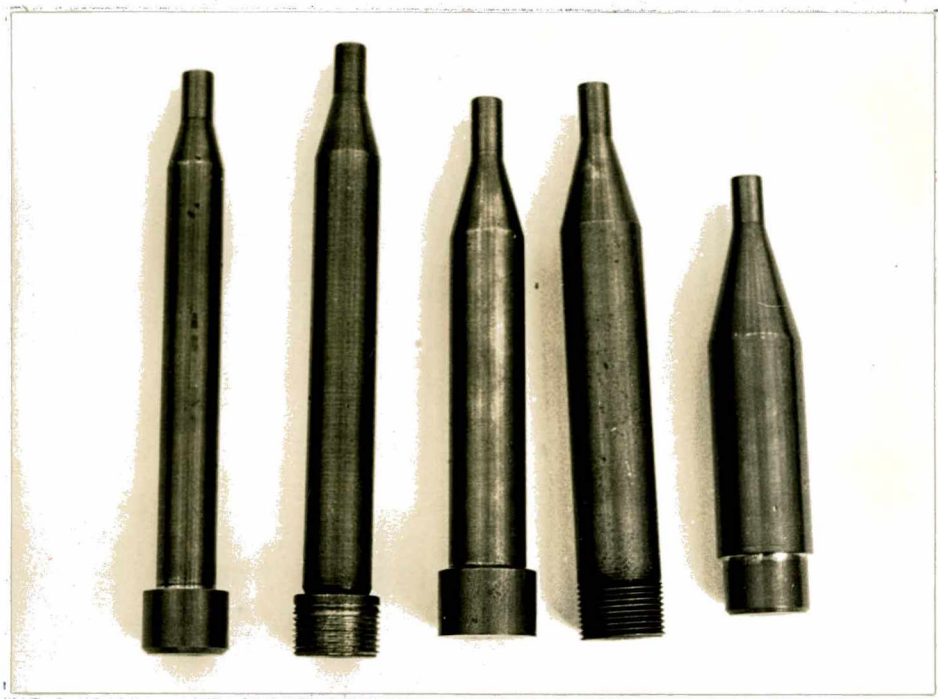
Fig. 32 - Biletos utilizados na extrusão do cobre (detalhe das várias relações de redução ensaiadas).
