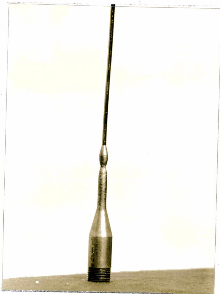
Fig. 4.38 - Idem figura anterior. Detalhe do escoamento indesejável do material (cobre).
