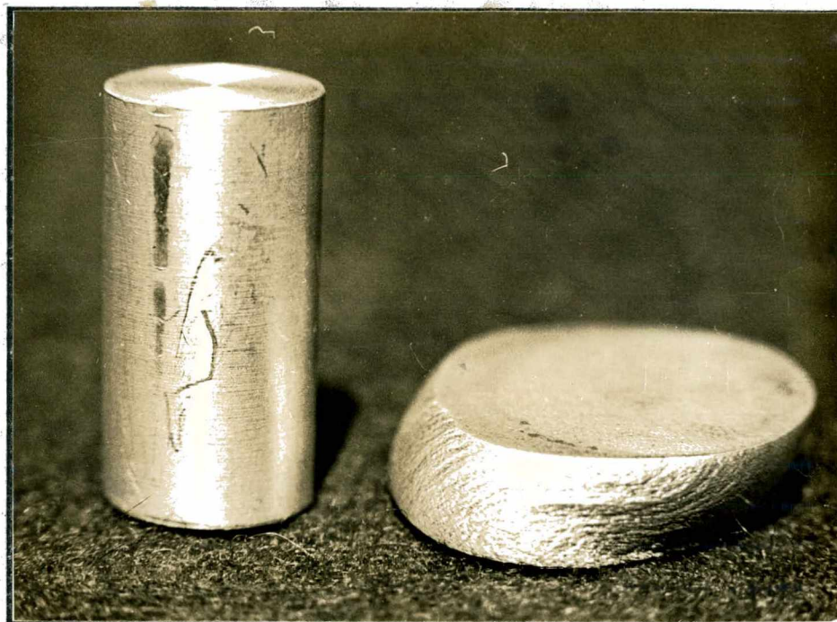
Fig. 37 - Corpo de prova para levantamento experimental da curva tensão-deformação (Relação 1/2 - Material: Alumínio) - Detalhe da ocorrência de escoamento lateral.
