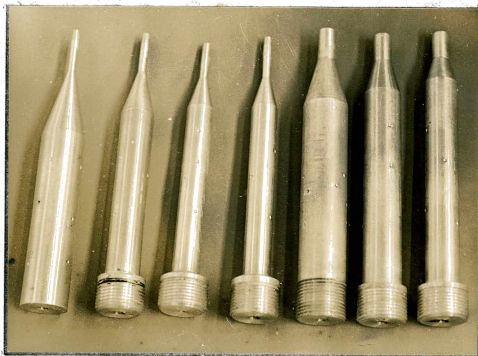
Fig. 29 - Biletes utilizados na extrusão do alumínio (detalhe das várias relações de redução empregadas).
