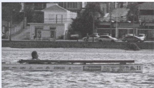
O catamarã desenvolvido é exclusivamente movido através da energia solar, que é obtida por 6 células fotovoltaicas localizadas no convés da embarcação.
