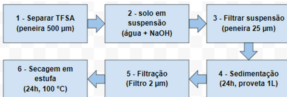
Figura 60: Fluxograma descrevendo resumidamente as etapas experimentais para a extração da fração argila a partir do solo.
