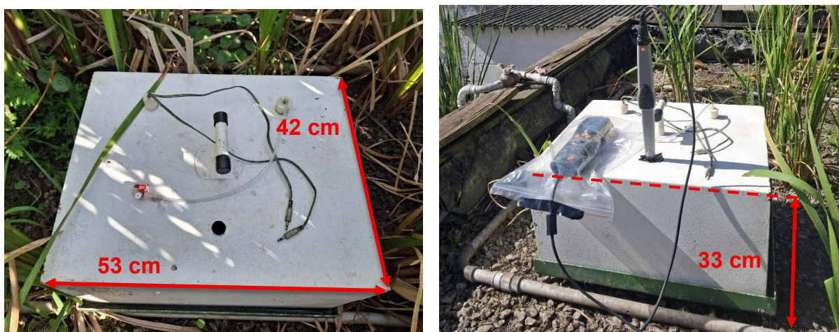
Figura 14. Vista superior e vista lateral da câmara estática utilizada no monitoramento das emissões gasosas com indicação de suas dimensões
