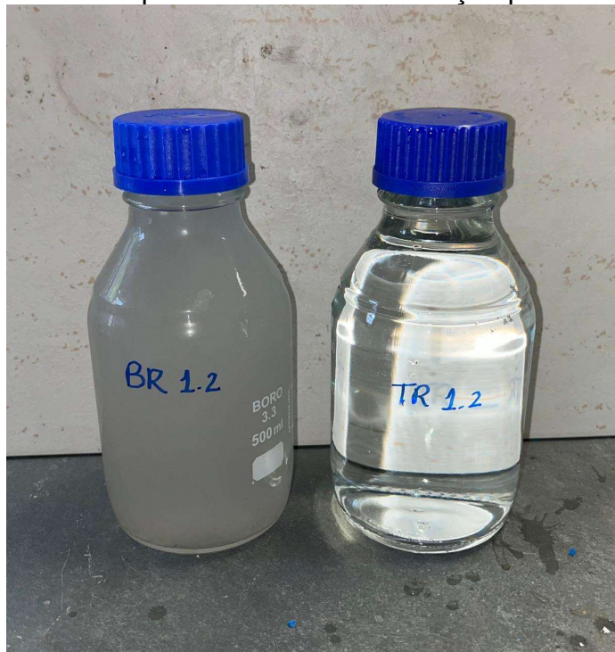
Figura 10 - Aspecto visual das AC bruta (à esquerda) e tratada (à direita) após o processo eletroquímico associado à filtração por membranas
