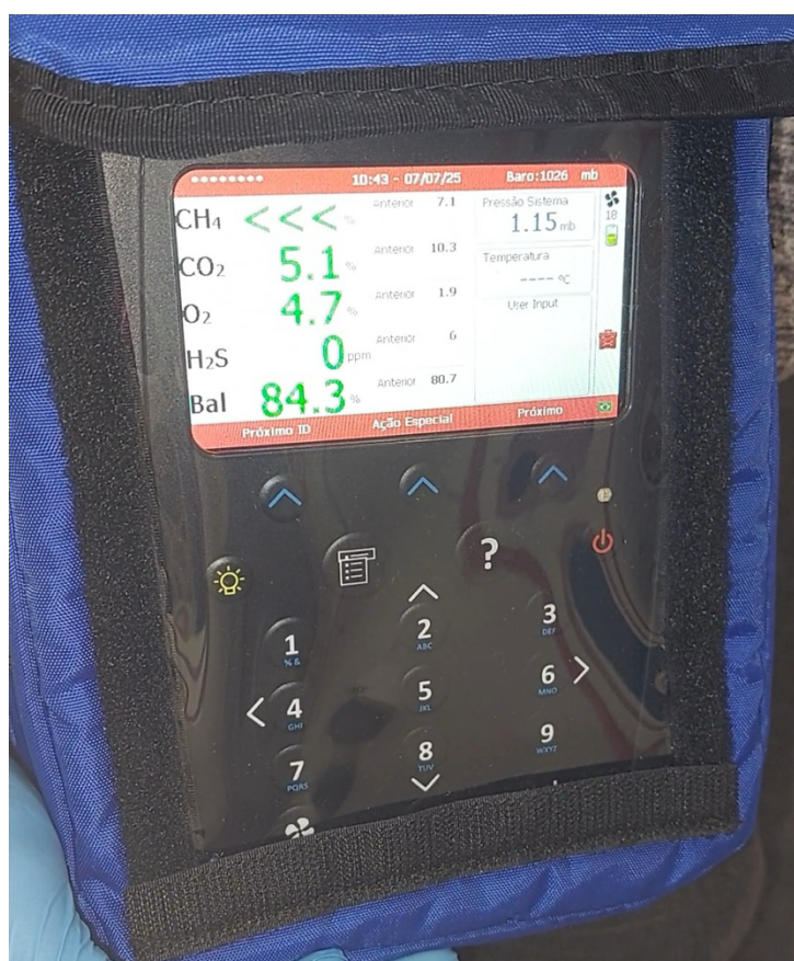
Figura 12 – Analisador portátil LANDTEC BIOGAS5000 utilizado na caracterização do biogás.
