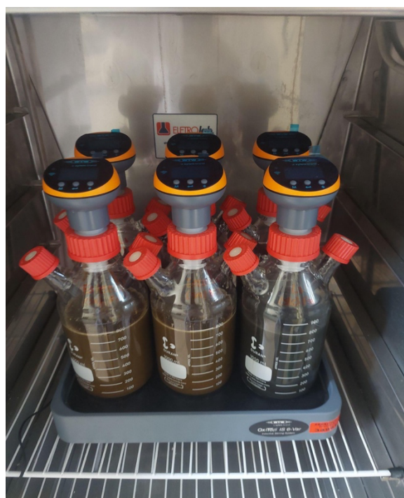
Figura 11 - sistema completo utilizado no ensaio com oxitop.
