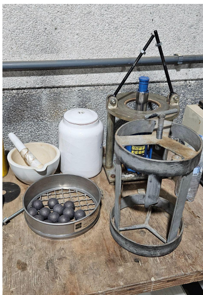
Figura 12 - Equipamentos do Moinho de Jarros e moedor manual
