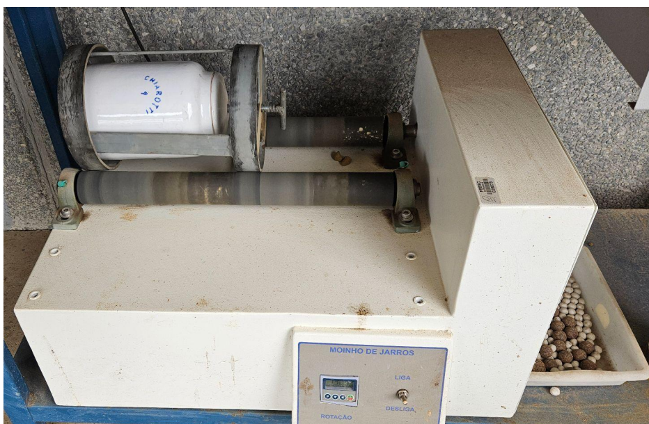
Figura 13 - Moinho de Jarros utilizado para moer o lodo têxtil calcinado
