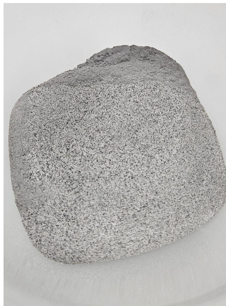
Figura 14 - Lodo têxtil calcinado em pó após moagem com diâmetro inferior a 0,075mm
