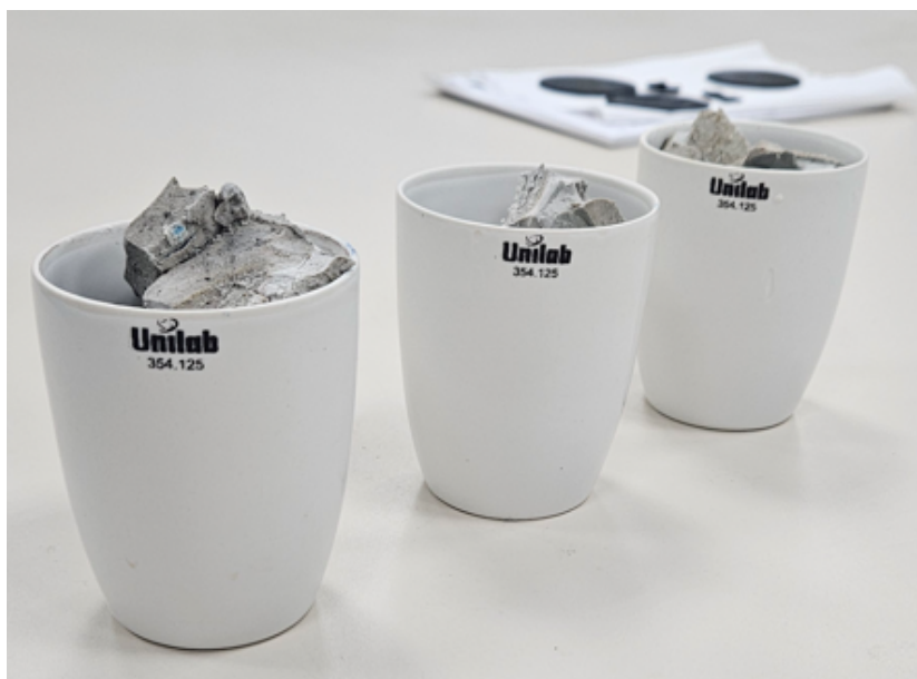
Figura 10 - Fracionamento em torrões do lodo têxtil para colocação na mufla.
