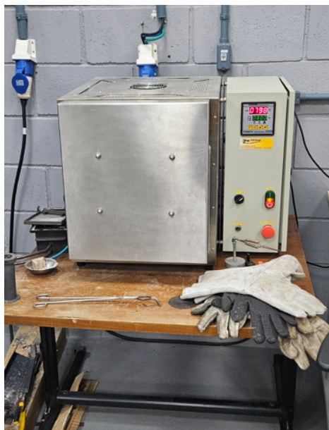
Figura 11 - Mufla utilizada para calcinação do lodo têxtil
