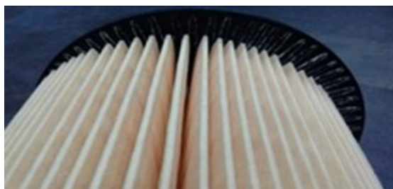
Figura 9 – Falta de inserção do papel na tampa
