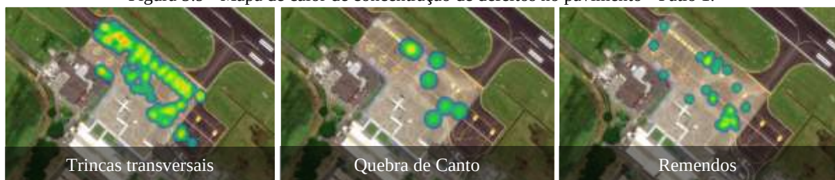
Figura 5.9 - Mapa de calor de concentração de defeitos no pavimento - Pátio 1.
