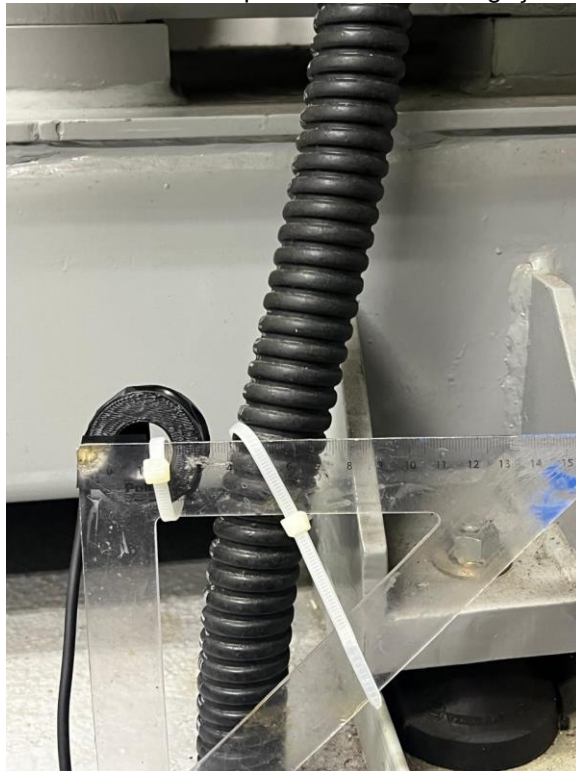
Figura 26 – Posicionamento do sensor próximo à caixa de ligação do gerador
