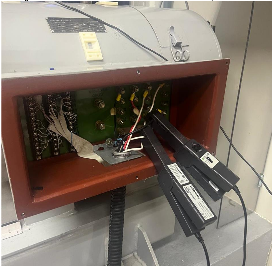
Figura 28 – Sondas de corrente medindo durante realização do ensaio
