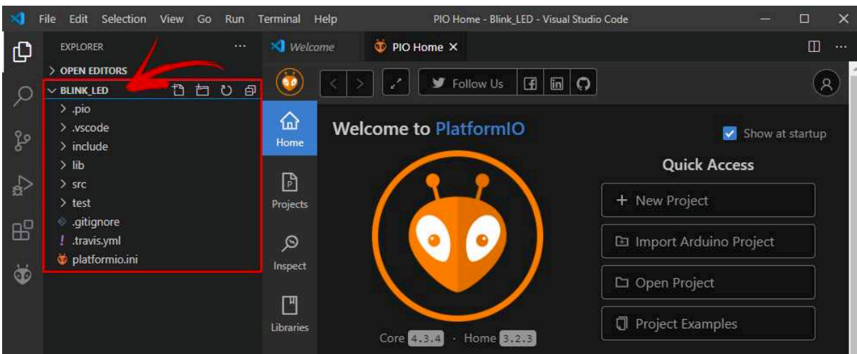
Figura A.3 – Árvore de arquivos criados pela PlatformIO no Explorer do VSCode.
