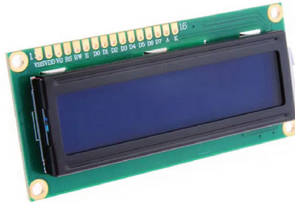
Figura 3.2 – Módulo de display LCD 16x2 para Arduino.
