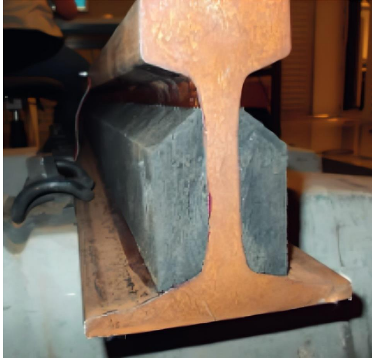
Figura 16 - Modelo de Atenuador de Massa Sintonizada testado em laboratório pelo autores Csontos, Augusztinovicz e Kazinczy (2020)
