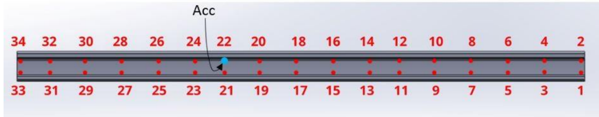
Figura 21 - Distribuição dos pontos a serem medidos no trilho
