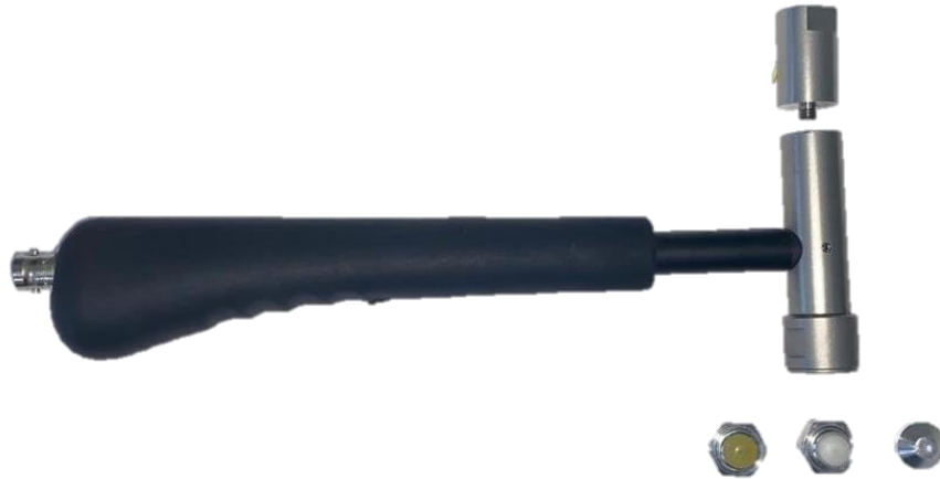
Figura 22 - Martelo de impactação utilizado na pesquisa
