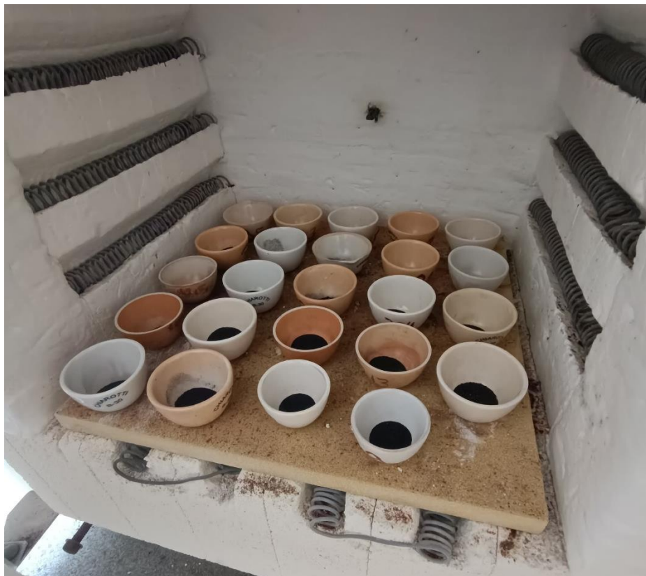
Figura 8 – Amostras na mufla para a análise do teor de cinzas
