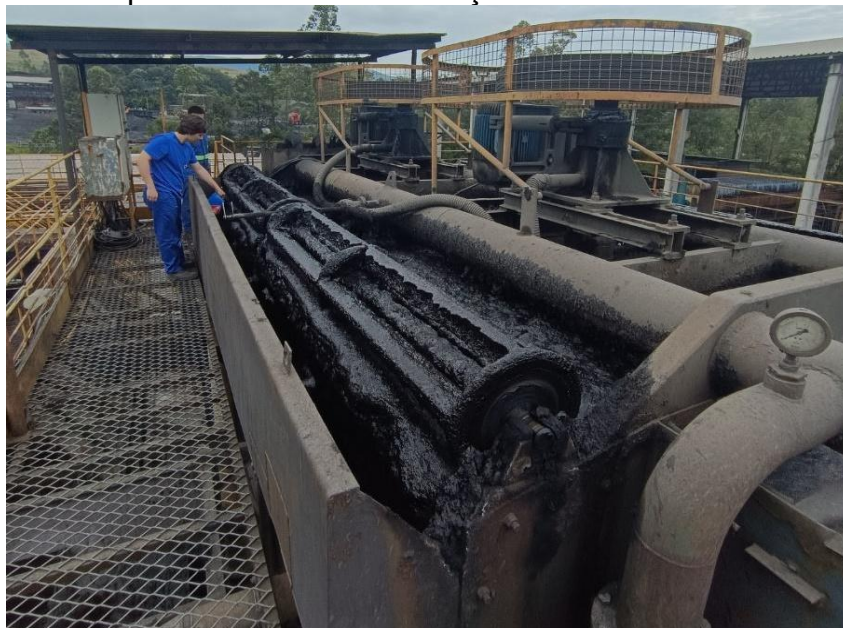
Figura 4 – Célula de flotação da empresa onde foram realizadas as coletas de amostras para os ensaios de flotação em bancada laboratorial
