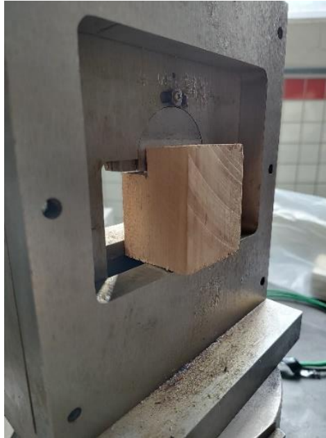
Figura 7– Aplicação da carga durante o ensaio de cisalhamento paralelo à grã.
