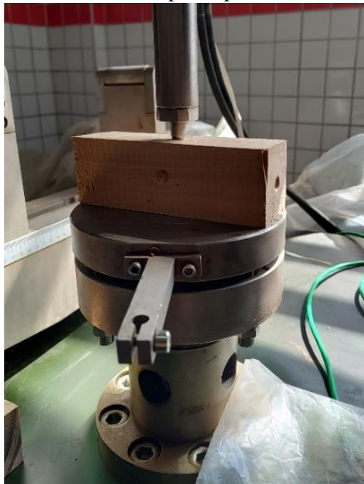
Figura 11 – Deformações causadas no corpo de prova durante o ensaio de dureza Janka.
