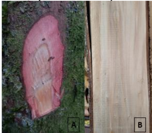
Figura 2– Madeira de Podocarpus lambertii . A) Aparência da casca interna e da madeira verde; B) Aparência da madeira após desdobro.
