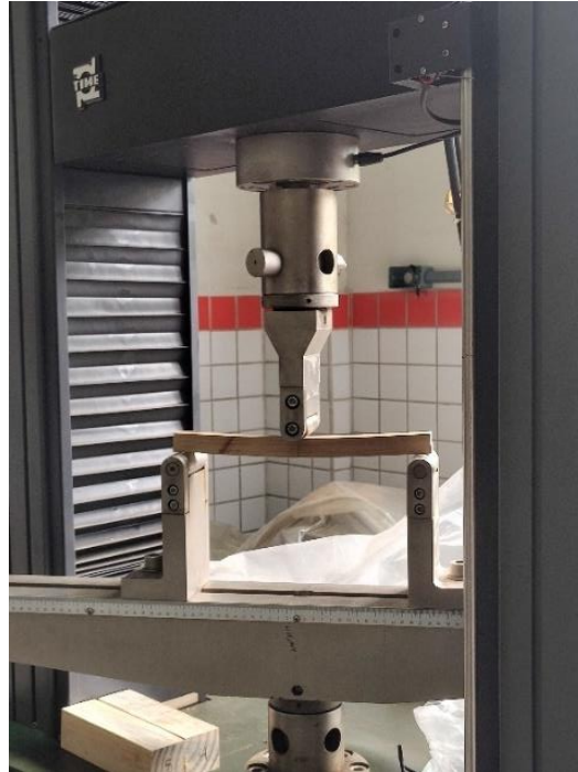
Figura 6 – Aplicação da carga durante o ensaio de flexão estática.
