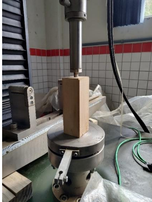
Figura 8 – Aplicação da carga no topo do corpo de prova durante o ensaio de dureza Janka.
