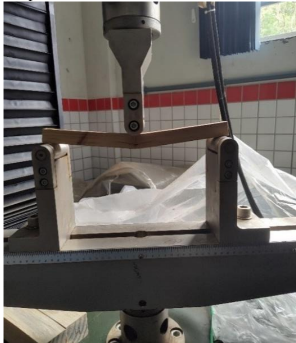
Figura 9 – Ruptura da madeira durante o ensaio de flexão estática.
