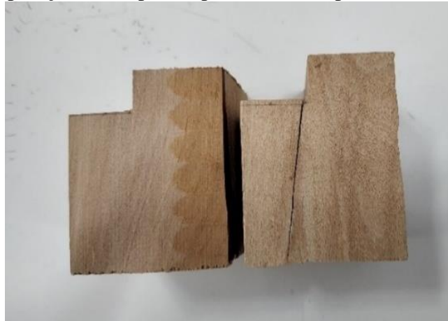
Figura 10 – Comparação de corpos de prova antes e após o ensaio de cisalhamento.
