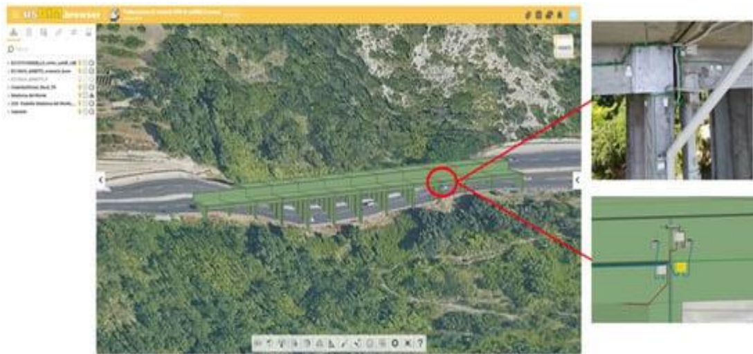
Figura 26 - Plataforma BMS e Integração GIS-BIM
