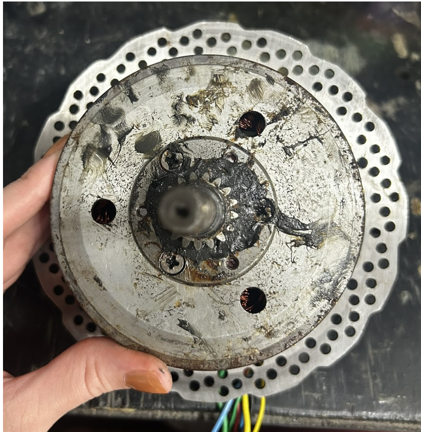
Figura 8 – Motor atual desmontado.
