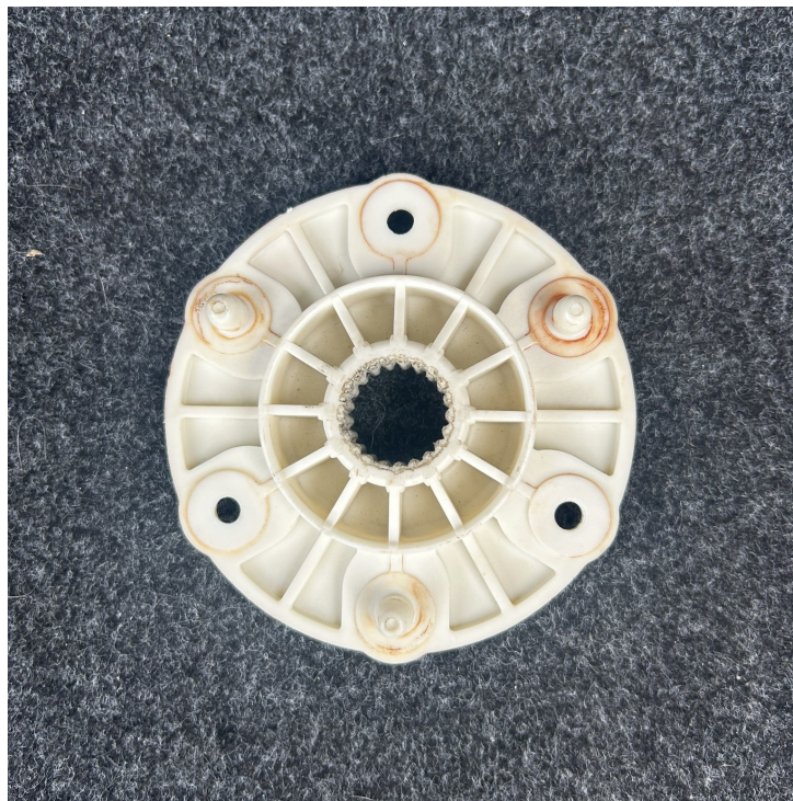
Figura 17 – Suporte original do rotor (vista externa).
