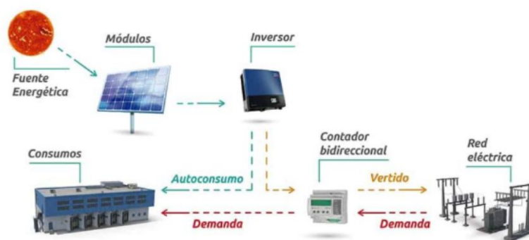
Figura 4 - Sistemas fotovoltaicos conectados à rede elétrica
