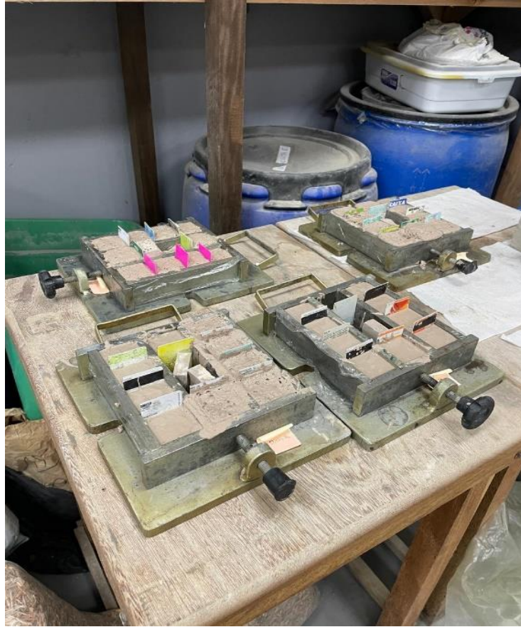
Figura 9 - Corpos de prova nos moldes
