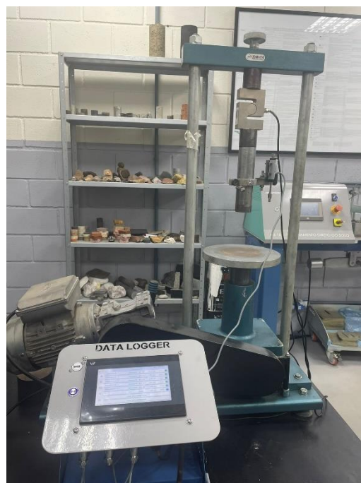
Figura 11 - Prensa CBR Usimachi equipada com um LVDT Lemaqs e um Datalogger Owntec
