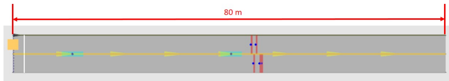
Figura 30 – Circuito com o conjunto de duas lombadas realizado no MotorcycleMaker
