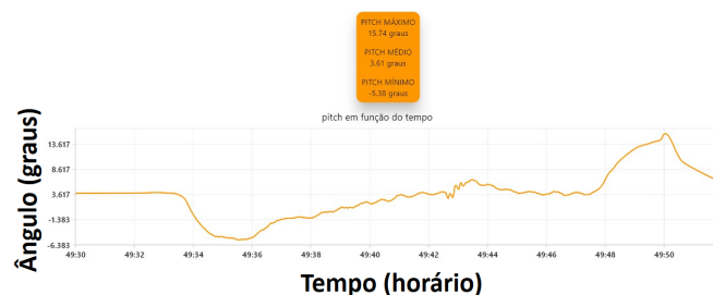
Figura 70 – Gráfico com resultados do teste experimental do trajeto com lombadas a esquerda à 20 km/h somente Pitch
