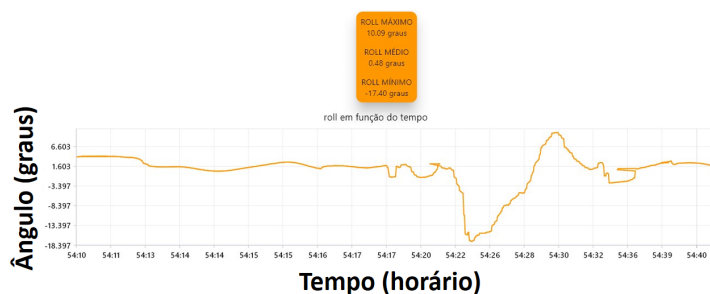
Figura 62 – Gráfico com resultados do teste experimental da rótula realizando apenas entrada e saída com velocidade de 30 km/h somente do Roll
