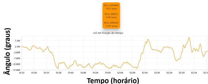
Figura 57 – Gráfico com resultados do teste experimental da rótula com velocidade de 30 km/h somente do Roll
