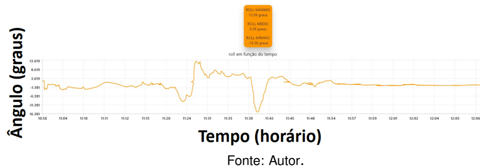
Figura 52 – Gráfico com resultados dos testes experimentais do circuito em formato de 8 somente entrando e saindo, somente do parâmetro de rolagem
