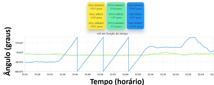
Figura 55 – Gráfico com resultados de Roll , Pitch e Yaw do teste experimental da rótula com velocidade de 30 km/h
