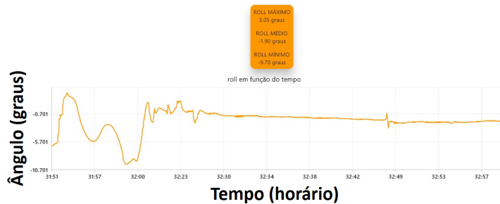
Figura 61 – Gráfico com resultados do teste experimental da rótula realizando apenas entrada e saída com velocidade de 20 km/h somente do Roll
