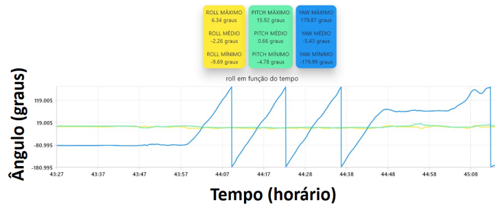
Figura 54 – Gráfico com resultados de Roll , Pitch e Yaw do teste experimental da rótula com velocidade de 20 km/h
