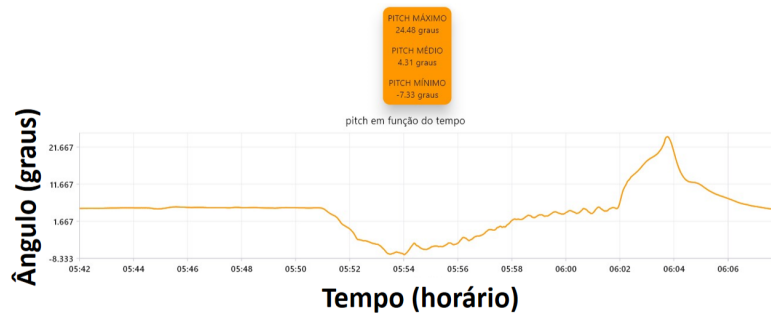
Figura 66 – Gráfico com resultados do teste experimental do trajeto retilíneo com velocidade de 30 km/h somente Pitch
