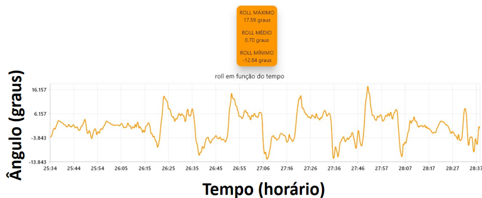
Figura 51 – Gráfico com resultados dos testes experimentais do circuito em formato de 8 com 3 voltas somente do parâmetro de rolagem
