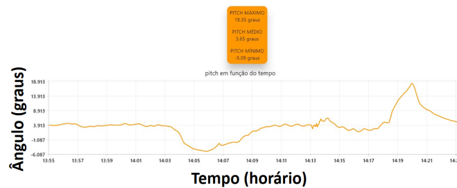
Figura 69 – Gráfico com resultados do teste experimental do trajeto com lombadas a direita à 20 km/h somente Pitch
