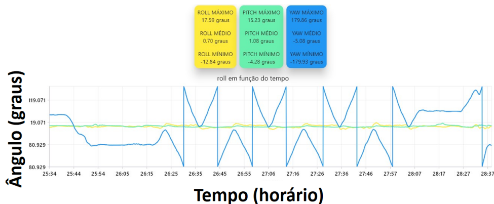
Figura 49 – Gráfico com resultados de Roll , Pitch e Yaw dos testes experimentais do circuito em formato de 8 com 3 voltas
