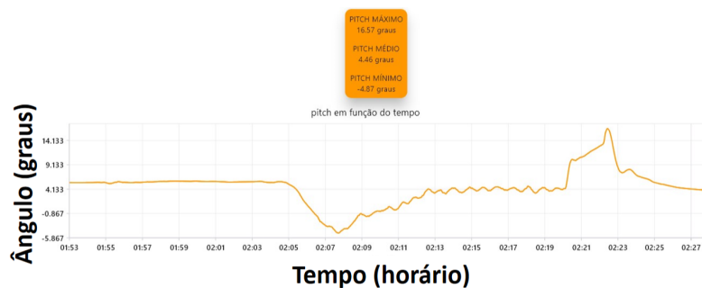
Figura 65 – Gráfico com resultados do teste experimental do trajeto retilíneo com velocidade de 20 km/h somente Pitch
