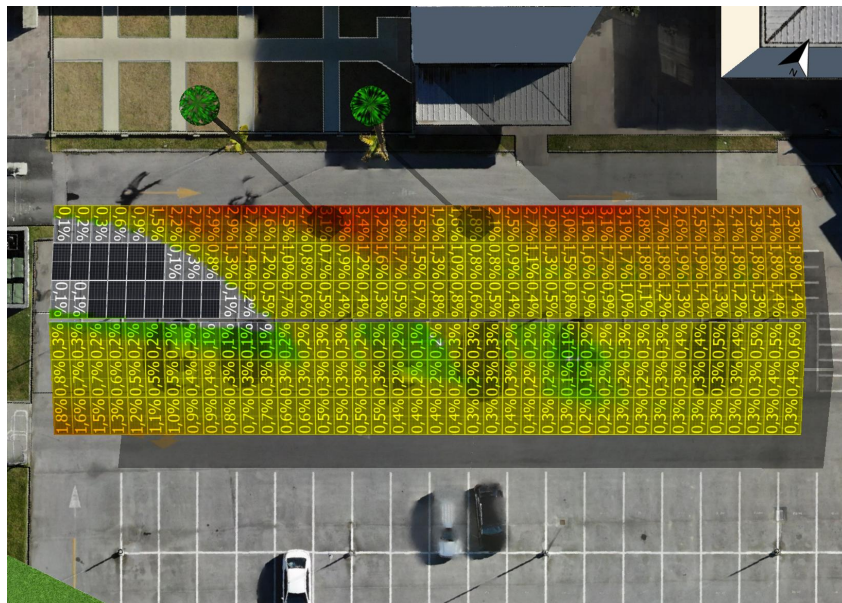
Figura 18 – Perfil de sombreamento do Carport.
