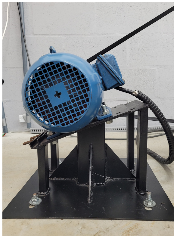
Figura 16 – Montagem final do sistema do suporte do motor elétrico
