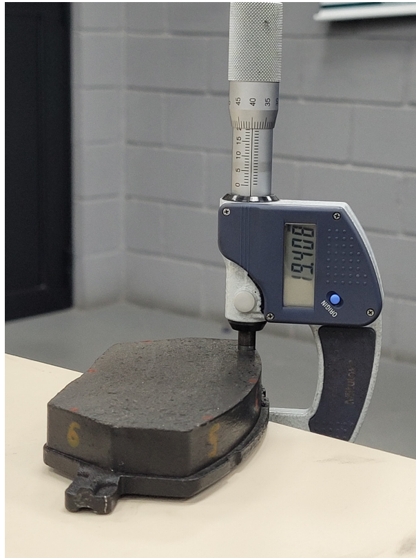
Figura 26 – Medição da espessura em um ponto da pastilha
