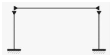
Pilares engastados na fundação e viga ligada rigidamente aos pilares;
