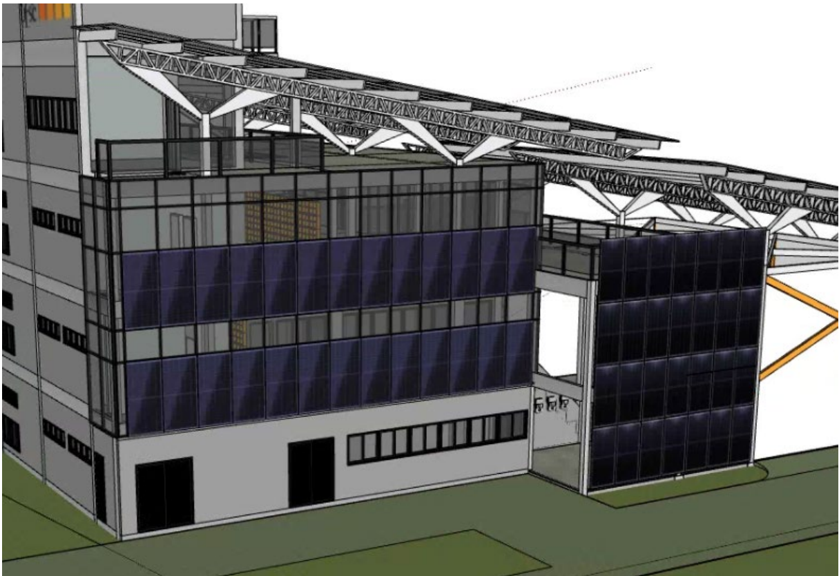
Figura 20 – Instalação do sistema FV na face leste – FV UFSC
