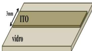
Figura 21 - Representação ilustrativa do substrato após o processo de decapagem do ITO.
