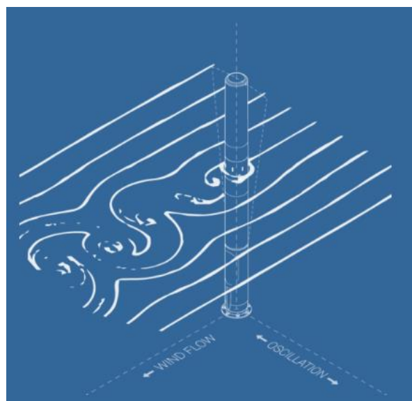
Figura 28 - Princípio de funcionamento Vortex Bladeless.
