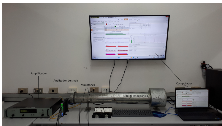
Figura 22 – Bancada com tubo de impedância junto aos microfones utilizados para realização dos testes.
