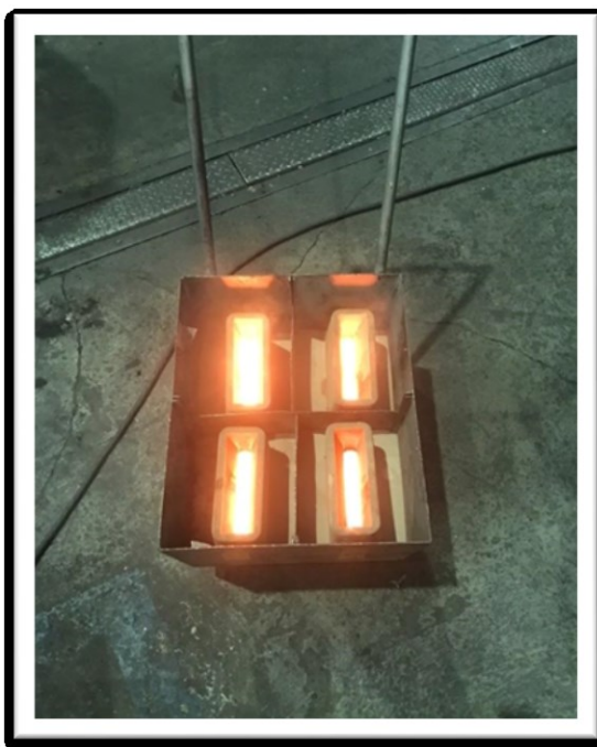
Figura 20- Moldes com metal vazado
