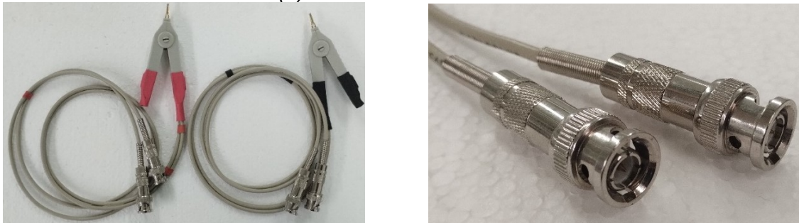
Figura 8 – Cabos R&S HZ184 com ponta de testes Kelvin. (a) O par de cabos utilizados. (b) Detalhe dos conectores BNC.
