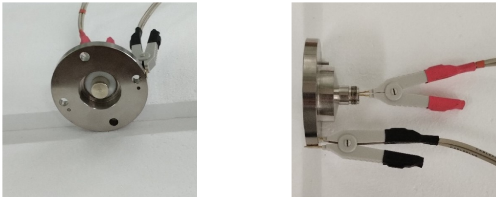
Figura 18 – Ensaio de circuito aberto com a sonda coaxial e a HAMEG HM8118
